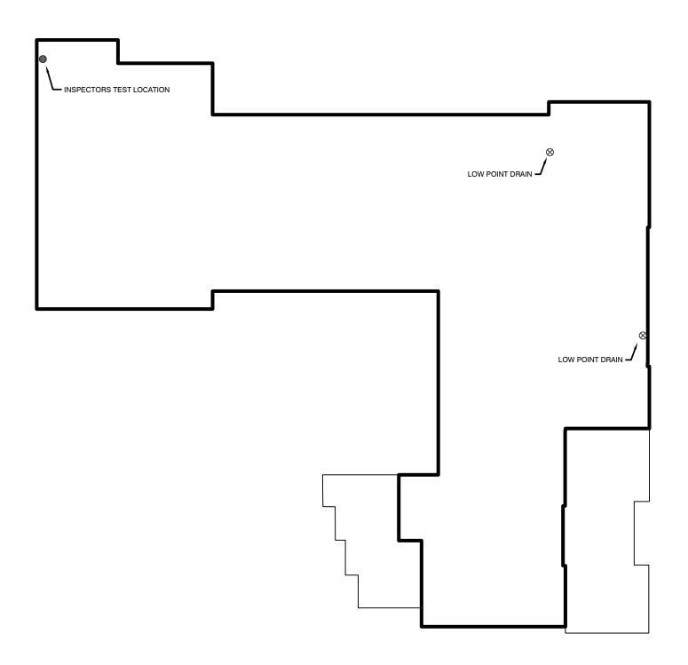
P1 DRY SYSTEM DRAIN PLAN
